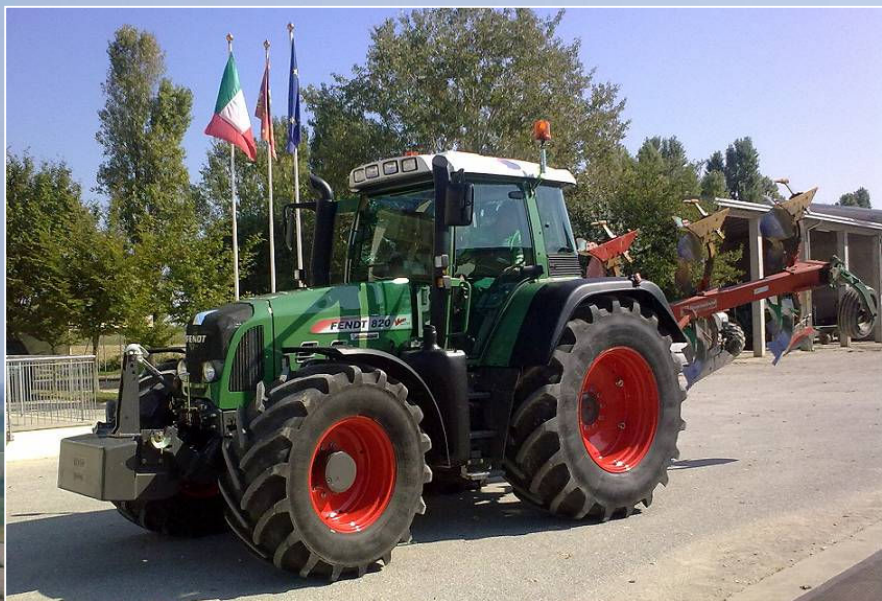
Fendt modello “820 Vario Greentec” dotato della doppia alimentazione gasolio/olio di colza
