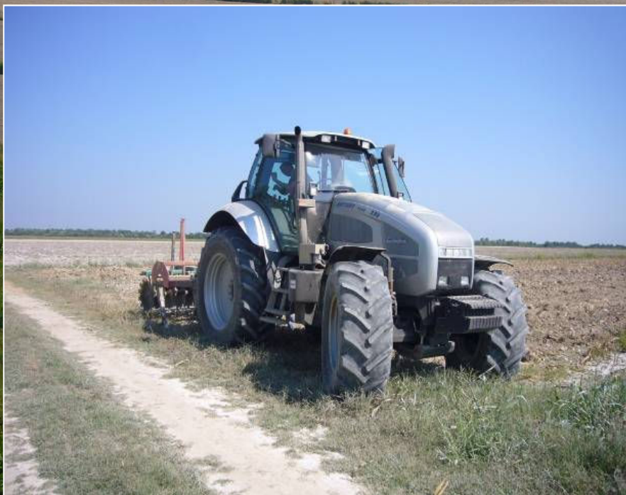
Lamborghini modello “Victory Plus 230” modificato con un particolare kit che permette di alimentare il motore con olio vegetale di colza.
