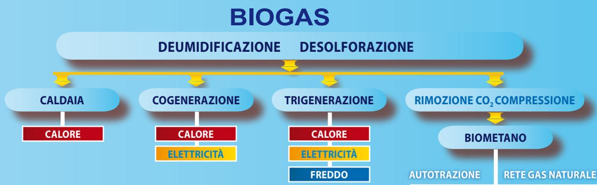
Per l'alimentazione di caldaie e cogeneratori sono richiesti alcuni semplici pretrattamenti del biogas, finalizzati alla rimozione dell'umidità e dell'idrogeno solforato ( $H_2S$ ), con lo scopo di evitare problemi di corrosione. Per la produzione di "bio-metano" è previsto un trattamento di eliminazione dell'anidride carbonica ( $CO_2$ ).
